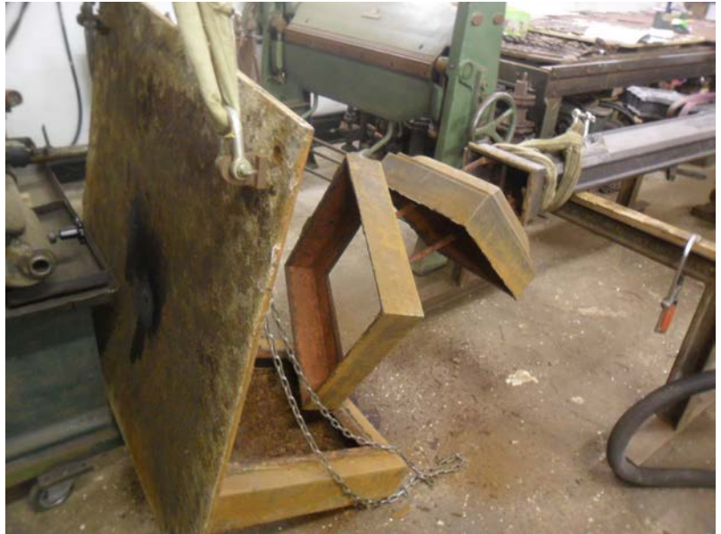
27 Nach Lösen der Muttern an den Zugstangen löste sich das Podest auf.
